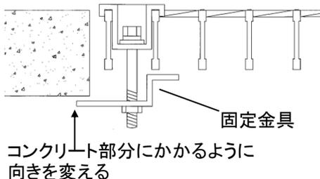
3、鉄筋などを利用して固定金具の回り止めをしながらボルトを締め込んでください。
